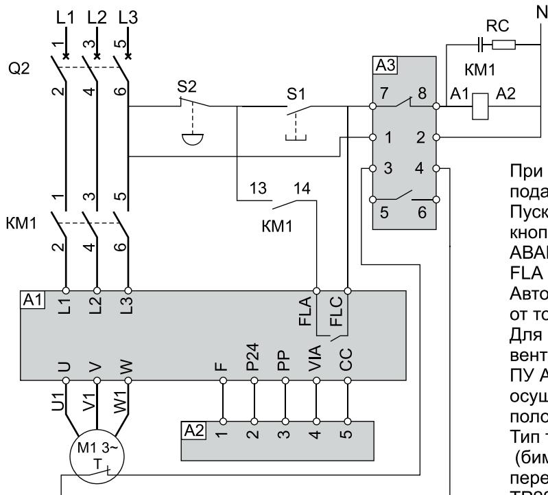
A1 - частотный регулятор ATV212;
