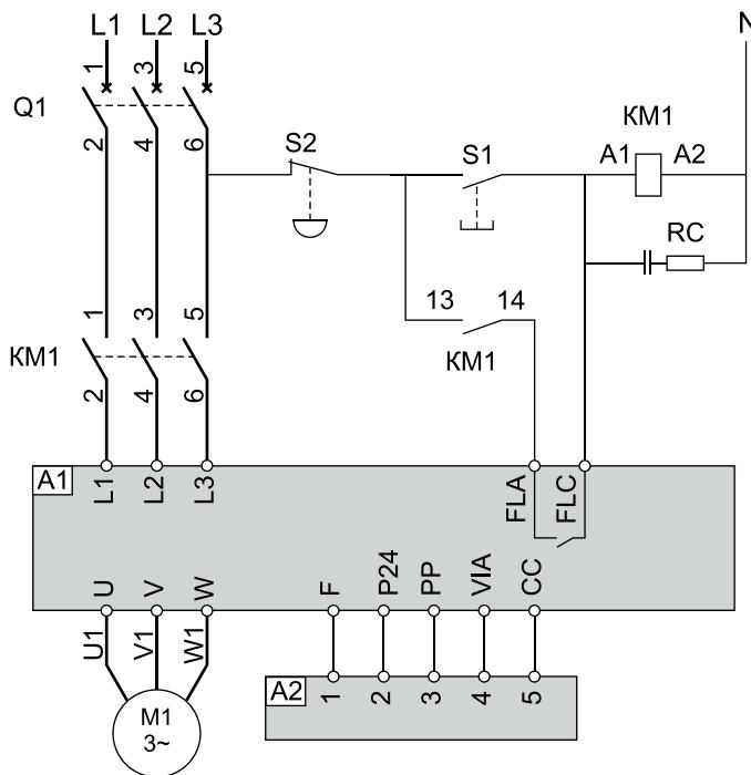
A1 - частотный регулятор ATV212;
