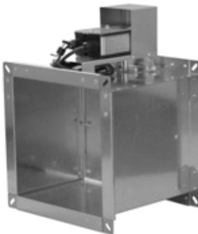
Конструкция клапана КПС-1м(60) представляет собой корпус, выполненный из оцинкованной стали, в который вставлена заслонка из огнеупорного материала. Заслонка переводится в рабочее положение приводом.
